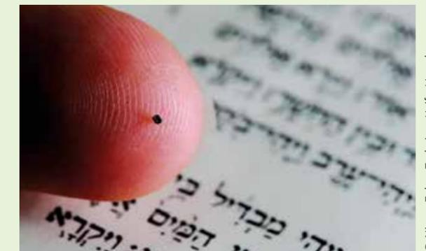
Die Gravur wurde mit einem Ionen-Beamer realisiert, geprägt auf einem Silicon-Chip mit einer 20 Nanometer dünnen Goldschicht. Um den Text lesen zu können, muss man ein Elektronenmikroskop verwenden, das 10.000 mal den Text vergrößert.
